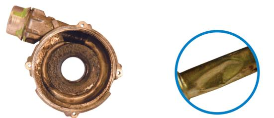
Residuos de aceite en las carcasas del compresor o de la turbina.
